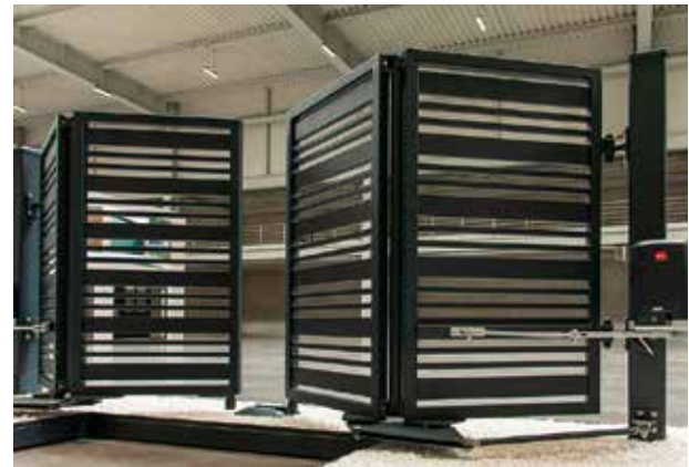
Das Tor wird mithilfe von Scharnieren und Seilzügen montiert, sodass keine zusätzliche Bodenschiene nötig ist.
