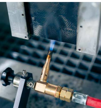
Die flammhemmende Folie Walki Wall Tight FR G A2 ist als nicht brennbar eingestuft.
